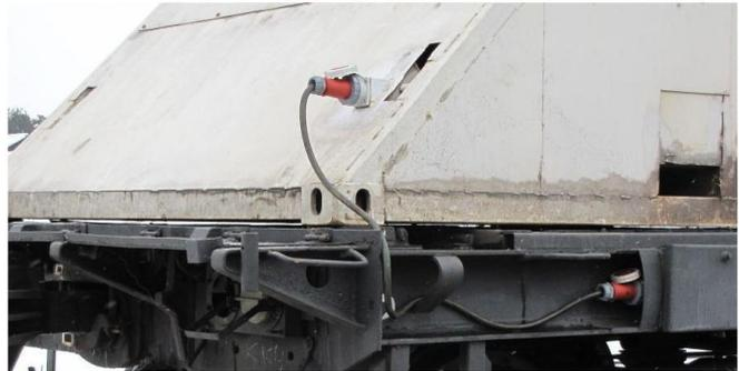
图 19: 将独立柴油发电机接入平车供电电路
