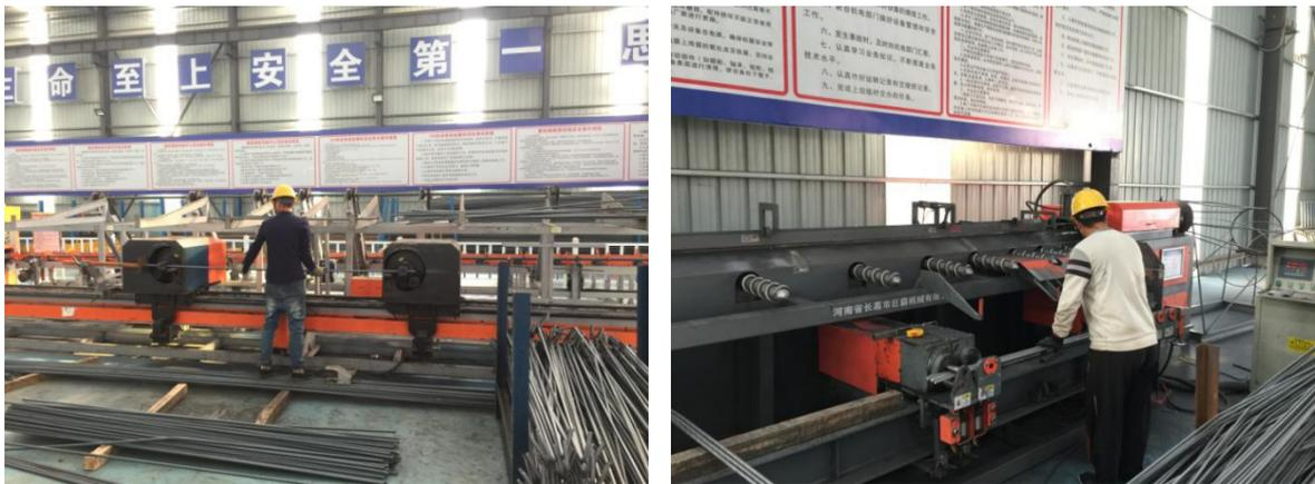
图 5.2.2-1 数控弯曲机进行钢筋加工
