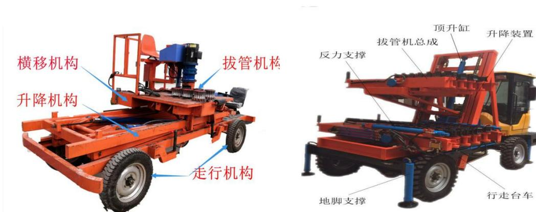
图 5.2.5-1 拔管穿束台车构造图
