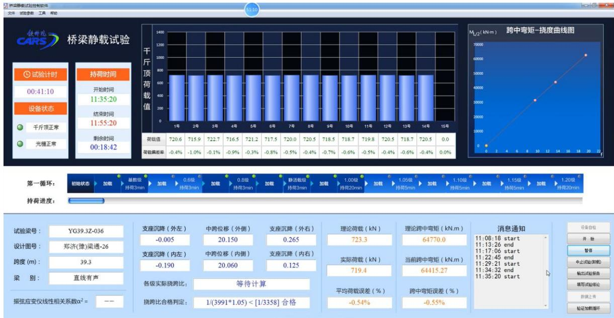
图 5.2.7-2 主控软件自动加载界面
