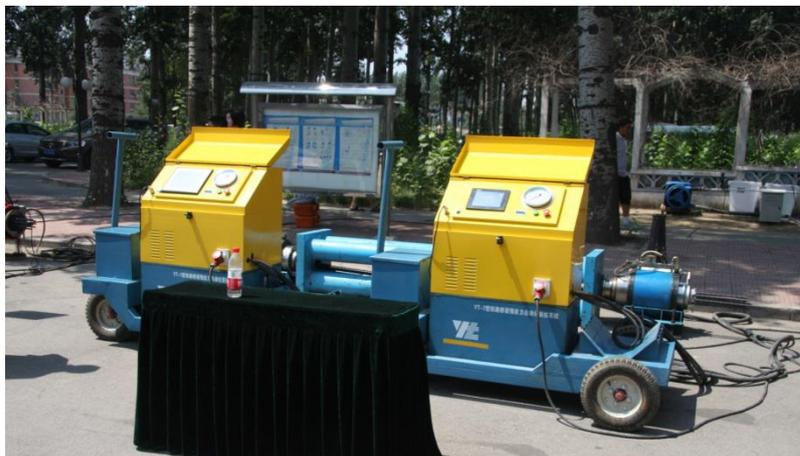
图 5.2.5-4 自动张拉控制系统
