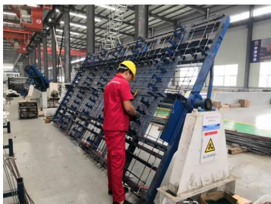
图 5.2.2-1 可翻转模式钢筋绑扎台
