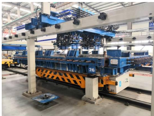
图 5.2.5-1 安装起吊套管与螺旋筋
