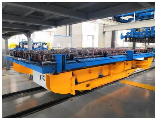
图 5.2.6-1 钢筋骨架专用胎具定位
