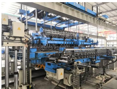
图 5.2.6-3 钢筋骨架自动定位入模
