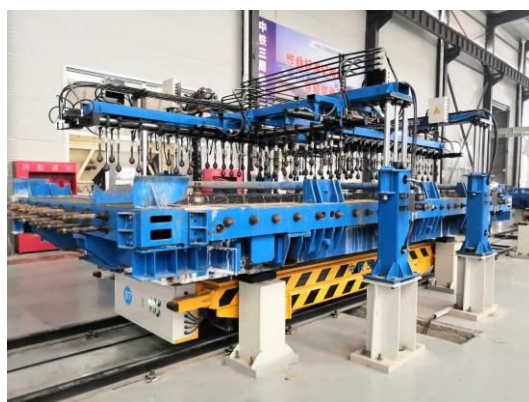
图 5.2.10-1 钢筋骨架绝缘性能自动检测
