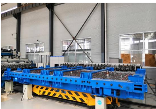
图 5.2.9-3 预应力筋张拉
