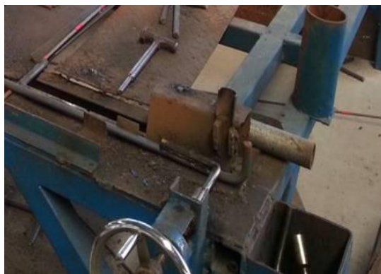
图 5.2.2-4 定位螺帽法定位
