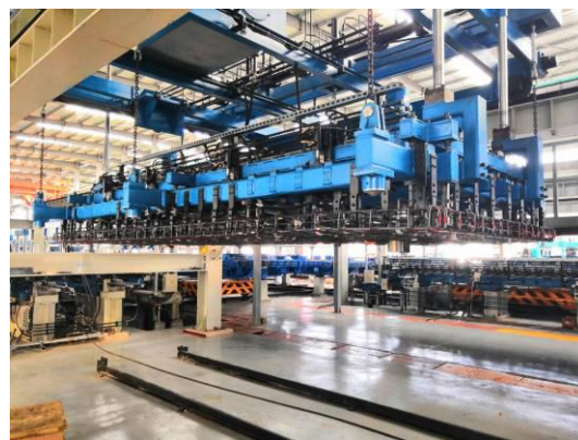
图 5.2.6-2 自动抓取钢筋骨架
