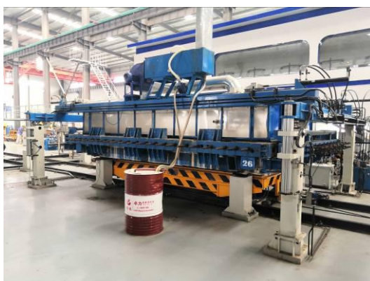
图 5.2.4-1 自动喷涂脱模剂
