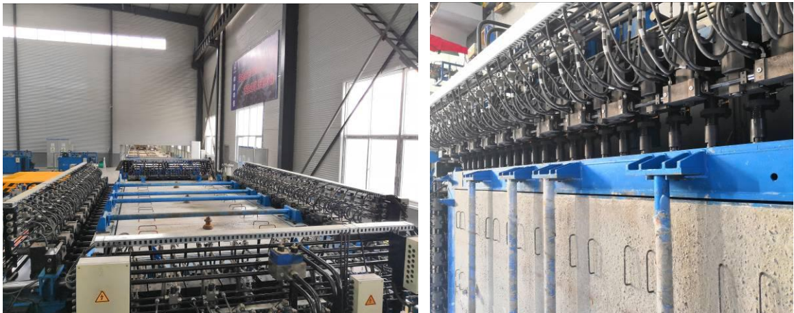
图 5.2.15-1 预应力钢筋自动放张
