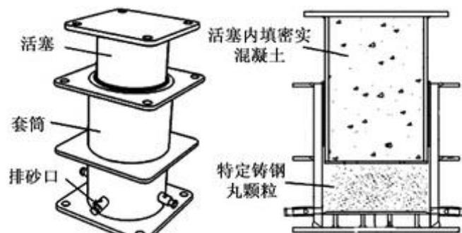
图 5.2.6-1 沙箱式卸载构造设计
