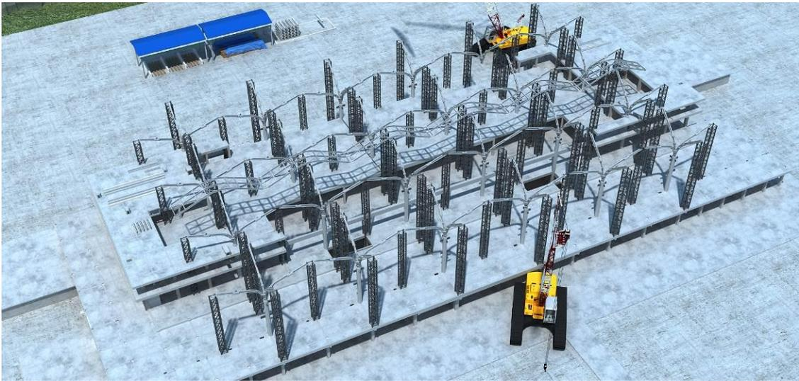
图 5.2.4-2 单元体屋盖安装顺序一：安装中间列“雁翅”屋盖
