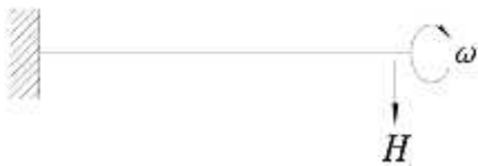
图B. 5 基于简支梁法的疲劳检验示意图
